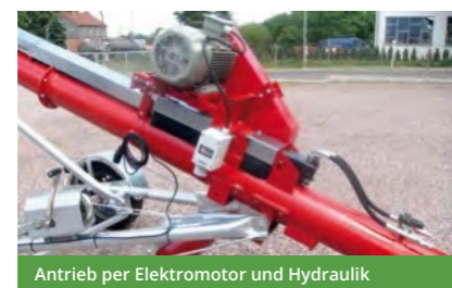
Antrieb per Elektromotor und Hydraulik
