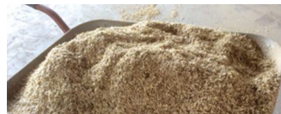
ZZ40 - Abreinigung Spreu, Spelzen und Bruchkorn am Windsichter bei Weizen aus ca. 3 Tonnen
