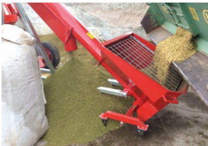
ZZ40 beim Reinigen von Sommergerste aus Öko Anbau mit sehr hohem Besatz
